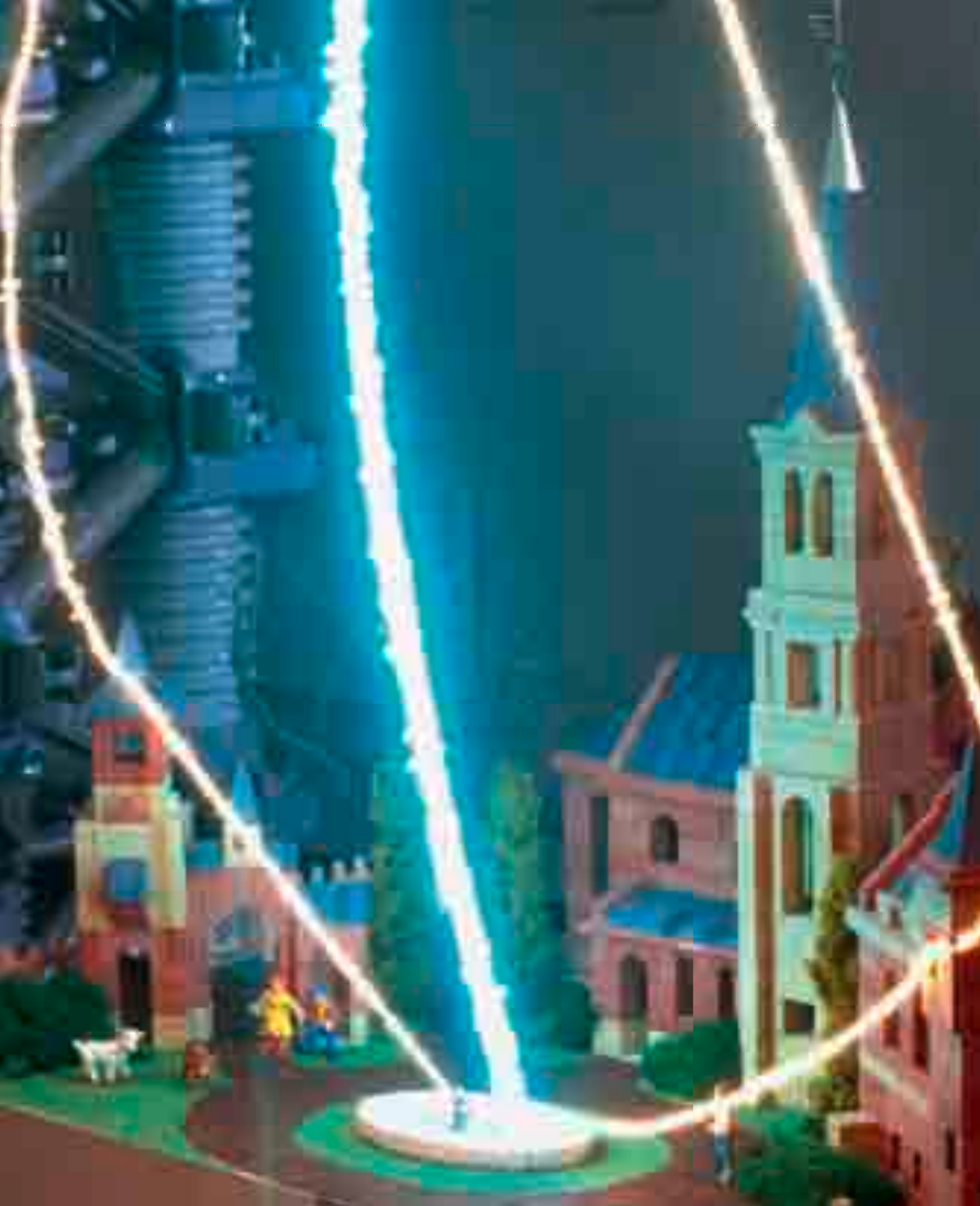
Bild oben: Ein Marx-Generator sorgt für Blitz und Donner in einem Spielzeug-Dorf (Foto: Jan-Peter Kasper).
